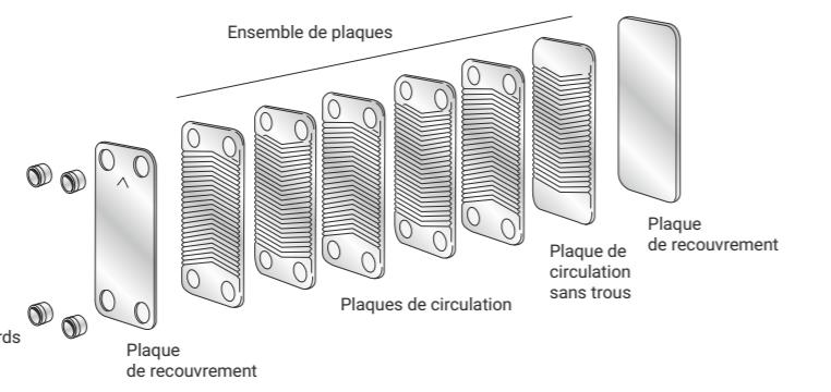
Durant le processus de brasage sous vide, un joint brasé est formé par capillarité autour de chaque point de contact de la structure en nid d'abeilles. Les fluides peuvent traverser l'échangeur de chaleur de différentes manières.
