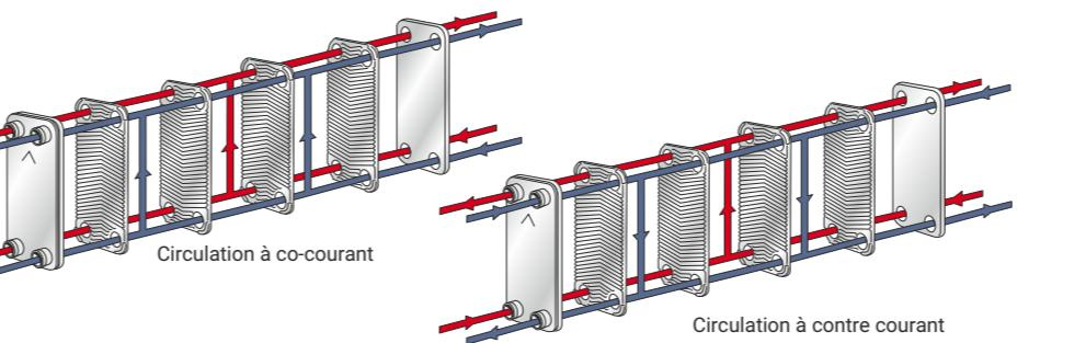
Pour les BPHE à circuits parallèles, il existe deux configurations possibles: à co-courant ou à contre-courant.
